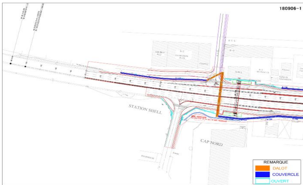
Figure 71: Plan de drainage prévu à l'Intersection de la Riviera 3
