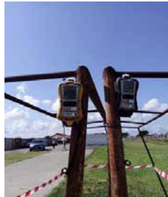
Mesures NO 2 , CO, SO 2
