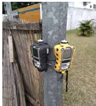
Mesures NO 2 , CO, SO 2
