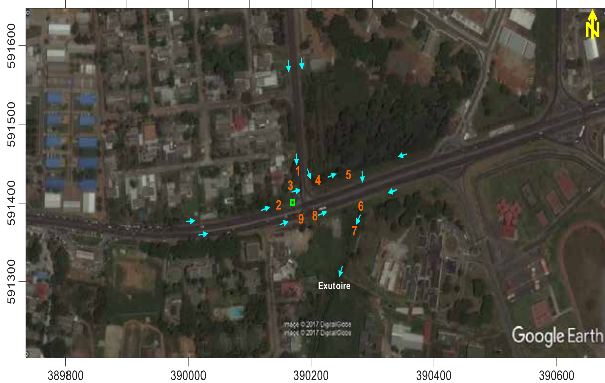
Figure 57: Drainage des eaux pluviales au niveau de l'intersection de l'Ecole de Police
