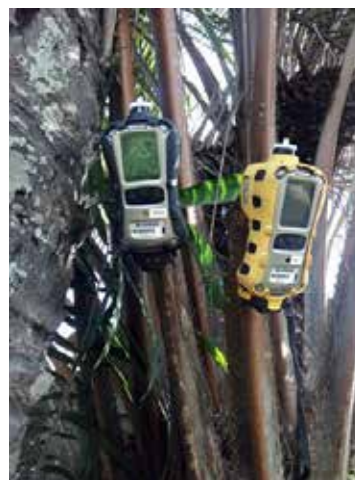
Mesures NO 2 , CO, SO 2
