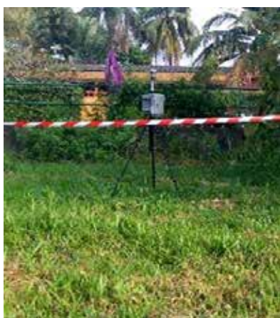
Mesures NO 2 , CO, SO 2
