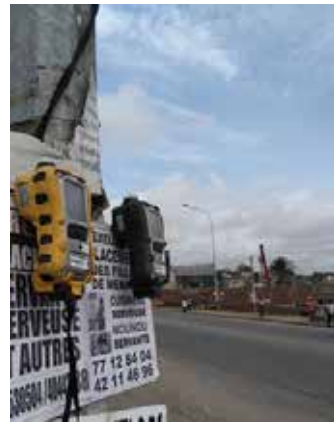
Mesures NO 2 , CO, SO 2
