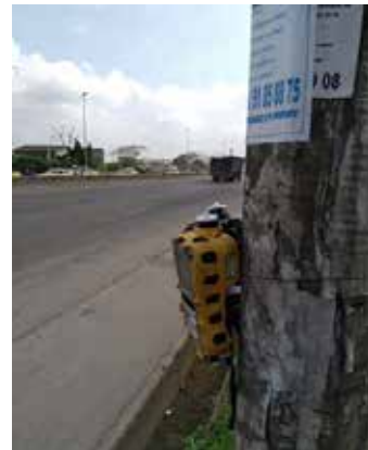
Mesures NO 2 , CO, SO 2
